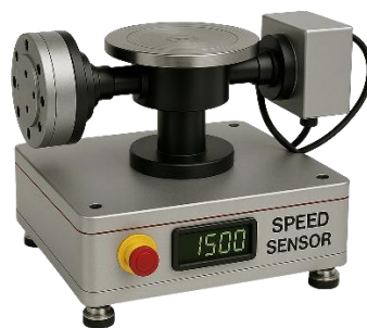
图 10 速度传感器测试台示意图
